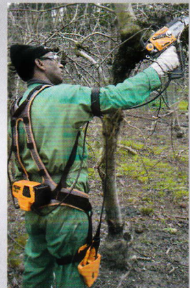
Obstbaumschnitt mit SELION M12 und PRUNION mit ULiB-Akku 250 für wechselnden Einsatz von Werkzeugen
